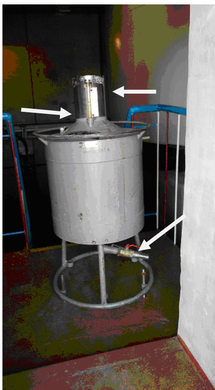
Рисунок 1 - Общий вид и схема пломбирования мерника
