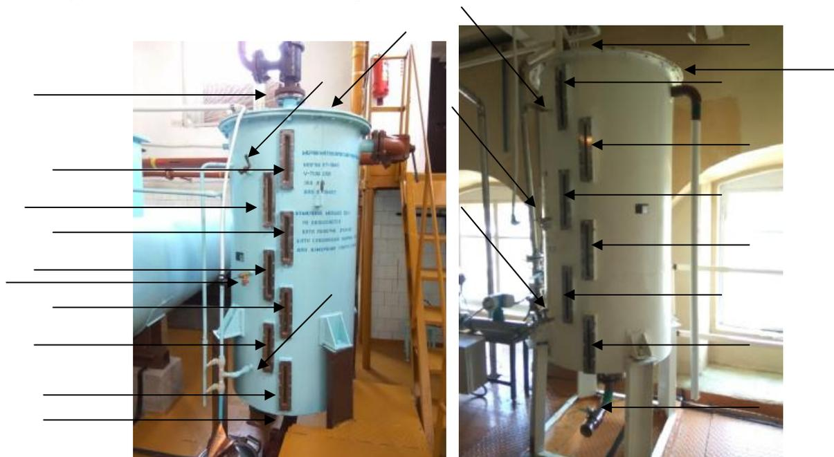
Рисунок 1 - Общий вид и места пломбирования мерника
