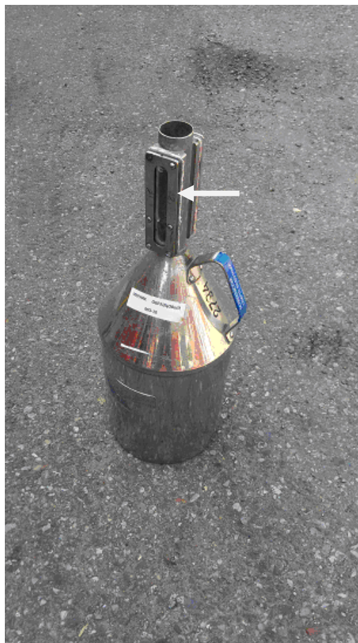
Рисунок 1 - Общий вид и места пломбирования мерника
