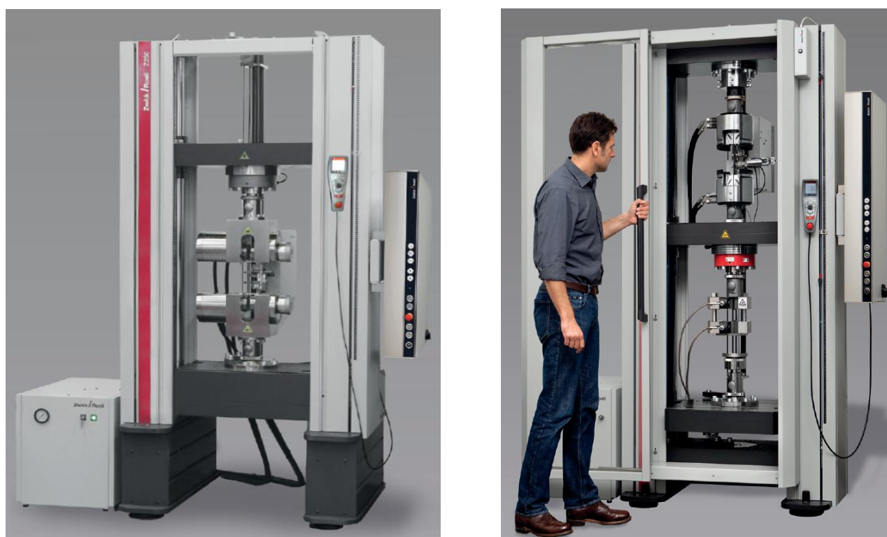
Рисунок 2 - Общий вид машин универсальных испытательных Z150, Z250
