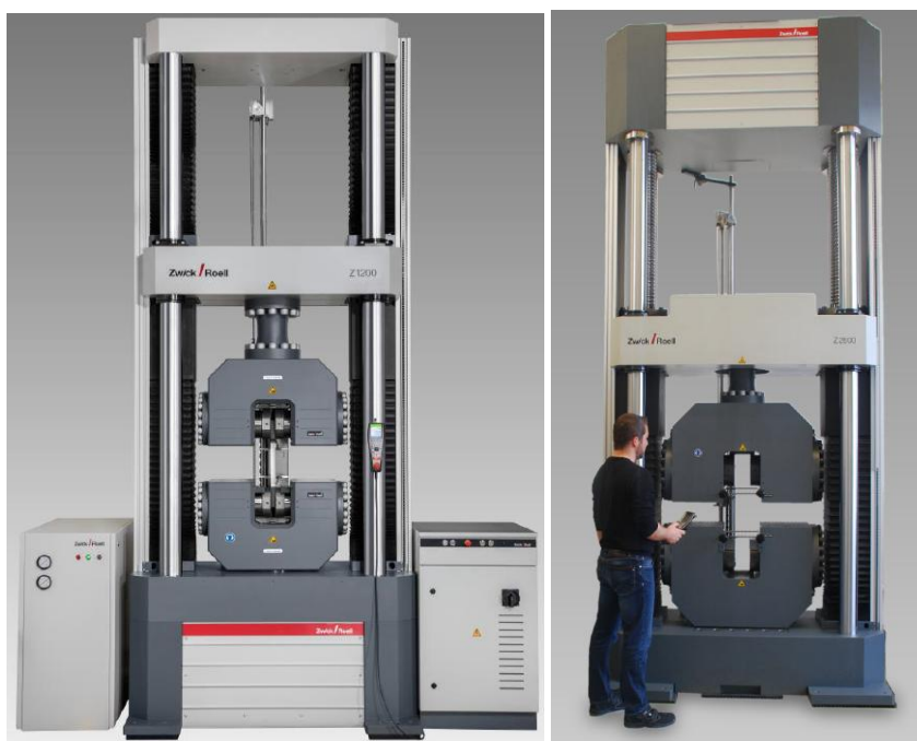
Рисунок 5 - Общий вид машин универсальных испытательных Z300, Z400, Z600, Z1200, Z1600, Z2000, Z2500 с электромеханическим приводом
