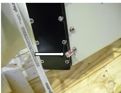
Рисунок 6 – Место пломбирования блока ультразвуковых преобразователей расходомера ультразвукового LEFM 240Si
