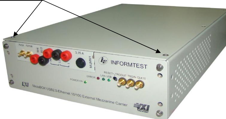
Рисунок 2 - Схема пломбировки от несанкционированного доступа мультиметров, установленных в устройство MezaBox
