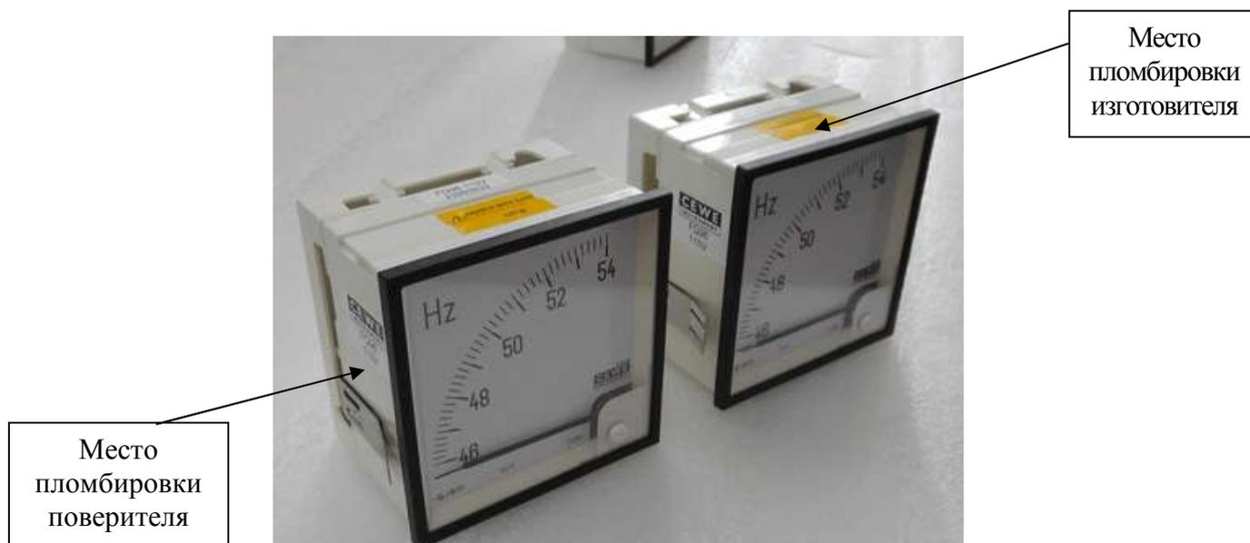
Рисунок 1 - Общий вид частотомеров FQ 96
