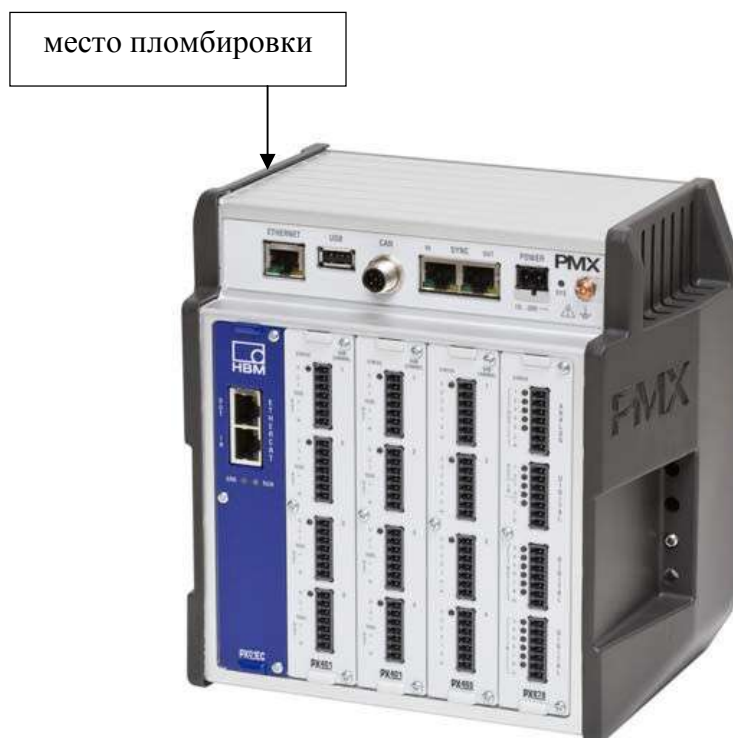
Рисунок 1 - Фотография общего вида и места пломбировки преобразователей
