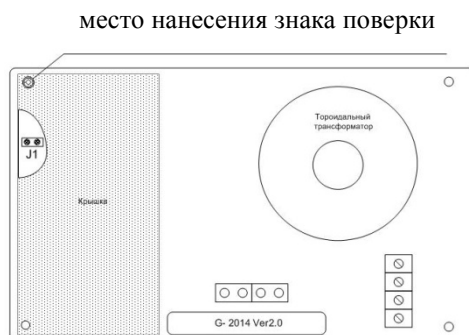
Рисунок 2 - Место пломбирования и нанесения знака поверки
