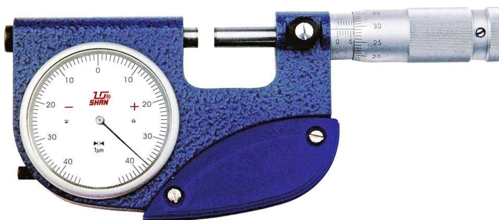
Рисунок 2 - Общий вид микрометров рычажных с диапазоном показаний стрелочного отсчетного устройства \pm 0,04 мм (арретир со стороны стрелочного отсчетного устройства)
