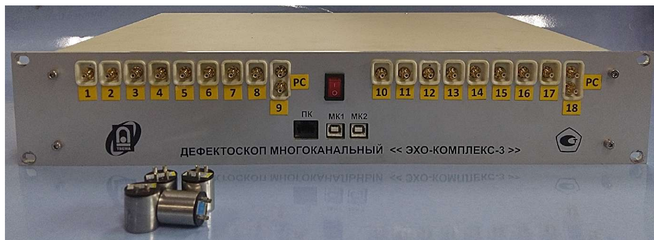
Рисунок 1 - Общий вид блока электронного дефектоскопа
