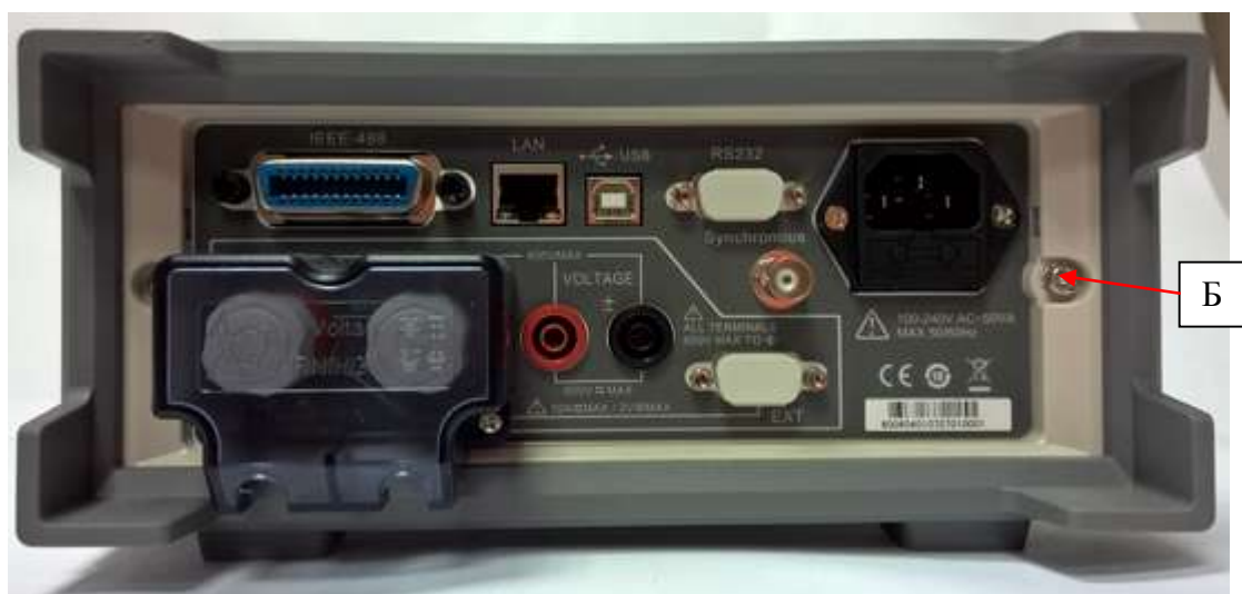
Рисунок 2 - Вид задней панели измерителей и схема пломбировки от несанкционированного доступа (Б)
