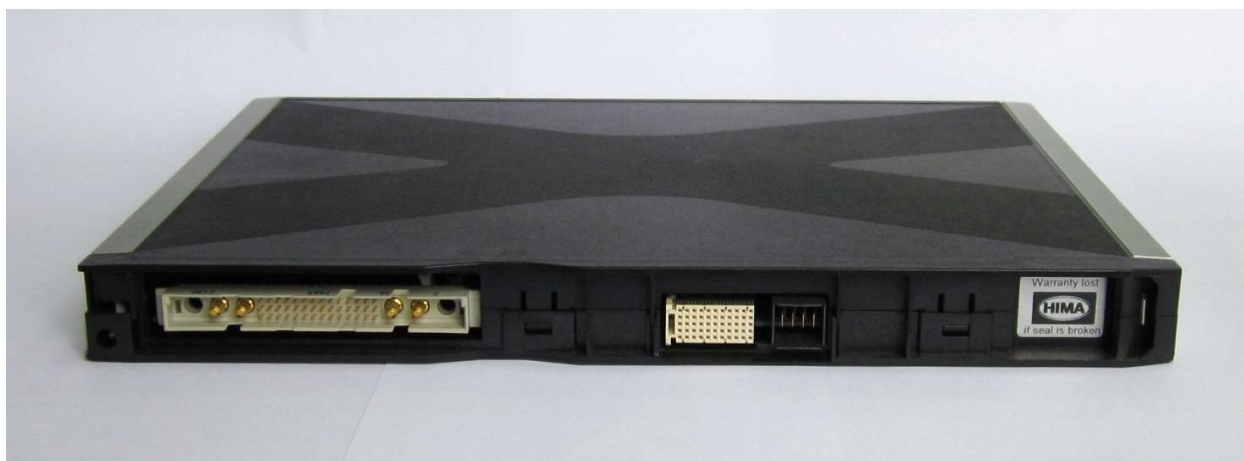
Рисунок 2 - Фотография места пломбировки от несанкционированного доступа (справа) на задней стороне модуля системы
