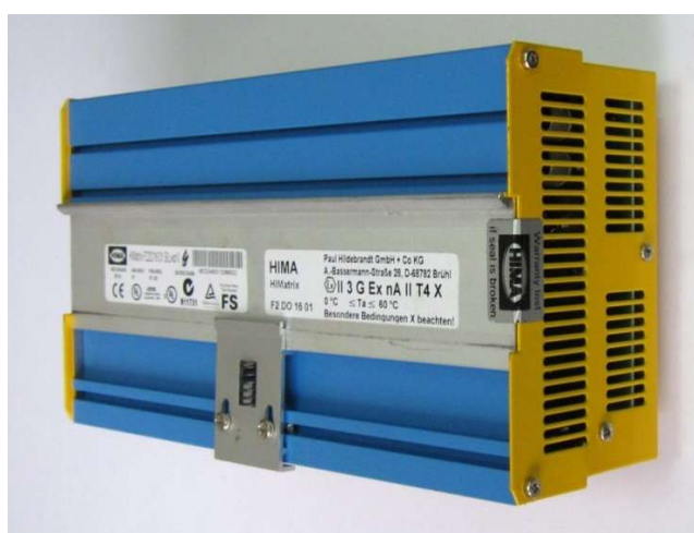
Рисунок 3 - Фотография места пломбировки от несанкционированного доступа (справа) на задней стороне контроллера
