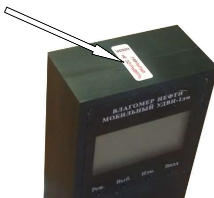
Рисунок 2 - Место пломбирования влагомеров нефти мобильных УДВН-1лм
