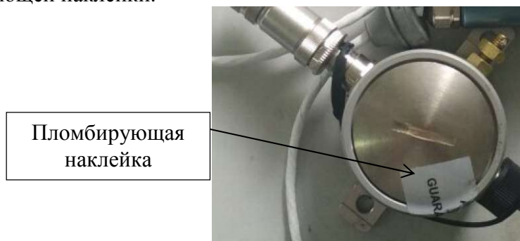
Рисунок 2 - Место нанесения пломбирующей наклейки
