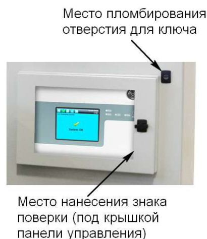
Рисунок 3 - Фото общего вида комплексов измерительных Touchpoint Plus, Touchpoint Pro с указанием места пломбирования и нанесения знака поверки
