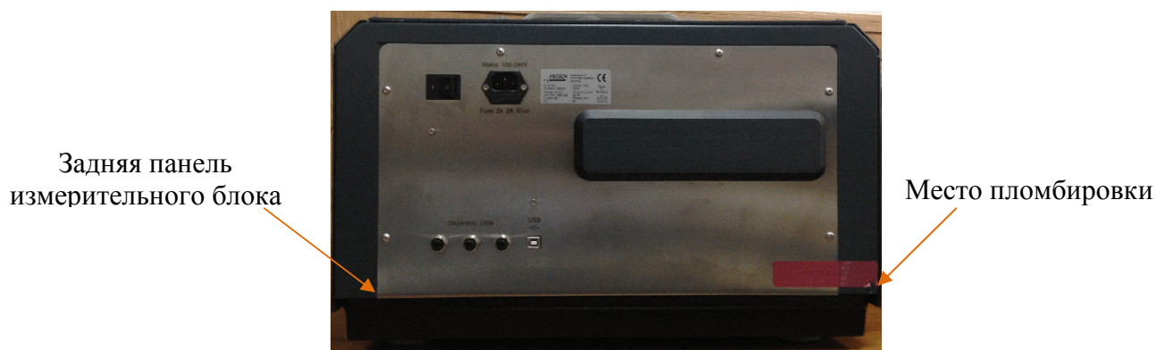
Рисунок 2 - Схема пломбировки анализатора
