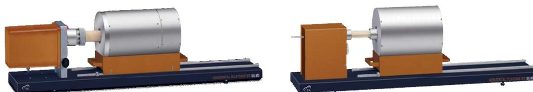
Рисунок 3 - Внешний вид дилатометров DIL803 и DIL803L (справа)
