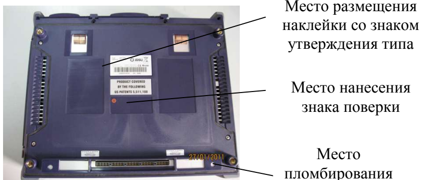
Рисунок 3 - Схема пломбировки от несанкционированного доступа, место размещения наклейки со знаком утверждения типа и знака поверки базового блока модификации MTS-8000E
