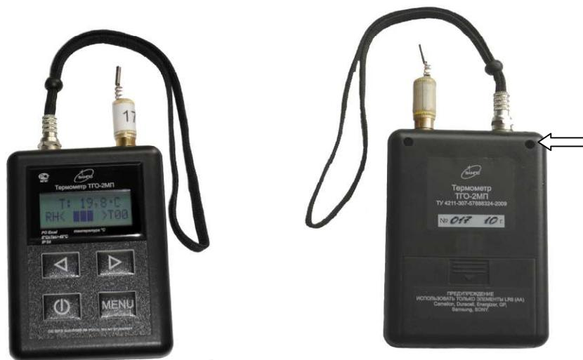
Рисунок 1 - Общий вид термометра и место пломбирования корпуса (указано стрелкой)
