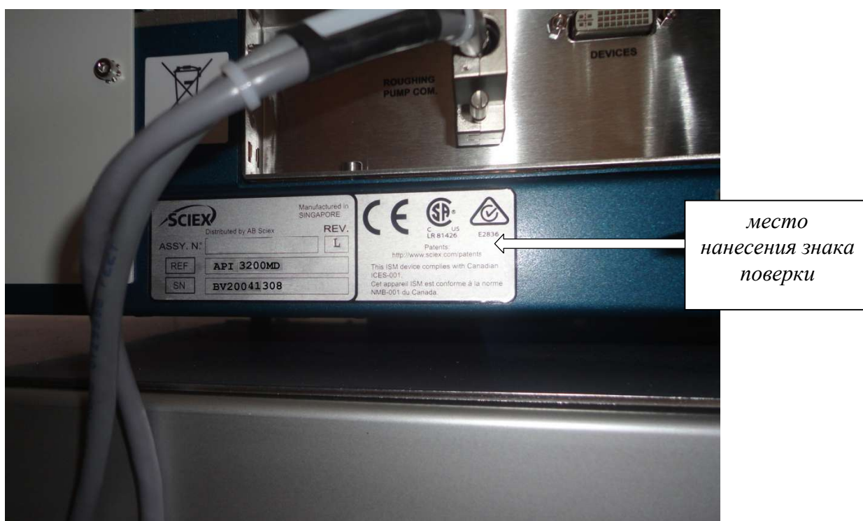
Рисунок 3 - Обозначение места нанесения знака поверки
