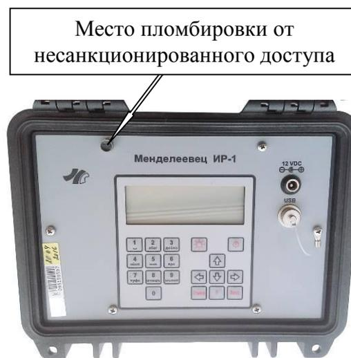
Рисунок 3 - Место пломбировки от несанкционированного доступа
