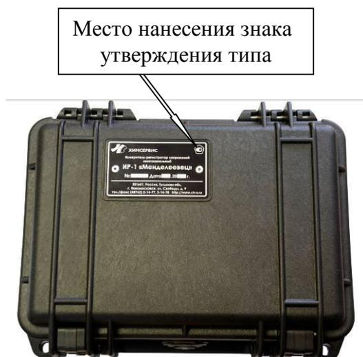
Рисунок 2 - Место нанесения знака утверждения типа
