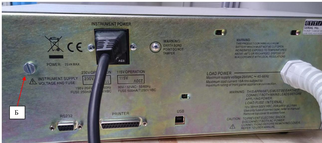
Рисунок 2 - Место пломбировки от несанкционированного доступа (Б)
