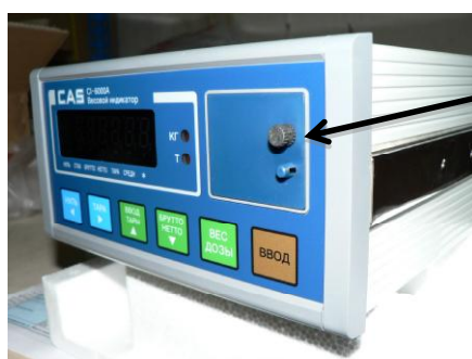
Рисунок 4 - Схема пломбировки блока управления
