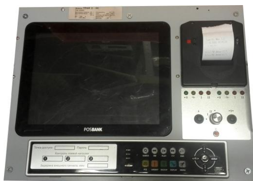
Рисунок 3 - Лицевая панель блока управления БУ
