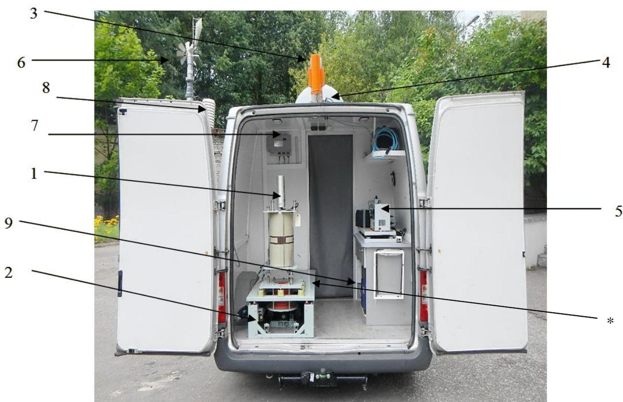
1 - детектор полупроводниковый серии GEM-20-7-SP4; 2 - устройство позиционирования для детектора полупроводникового с экраном-коллиматором; 3 - блок детектирования гамма-излучения БДКГ-04; 4 - Внешняя антенна АШН-660 к приемнику навигационному ProMark 120; 5 - аспиратор воздуха автоматический одноканальный АВА 1-150-02С; 6 - датчик параметров ветра; 7 - блок обработки данных БОД МК-14-2; 8 - датчик температуры воздуха; 9 - генератор Yamaha EF-1000iS, \* - место нанесения знака утверждения типа.
