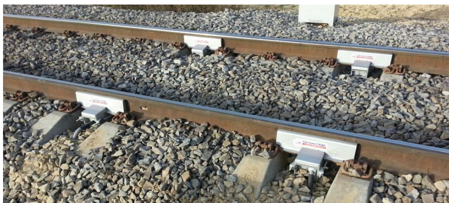
Рисунок 2 - Общий вид грузоприемного устройства системы
