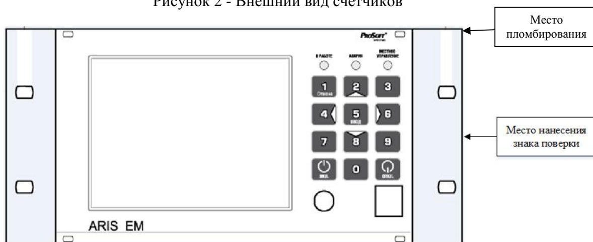
Рисунок 3 - Места пломбирования и нанесения знака поверки
