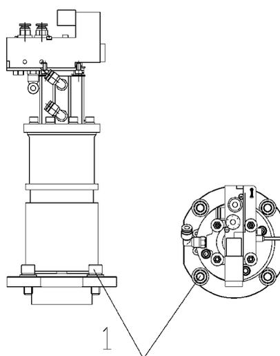
Рисунок 4 - Схема пломбировки установок от несанкционированного доступа
