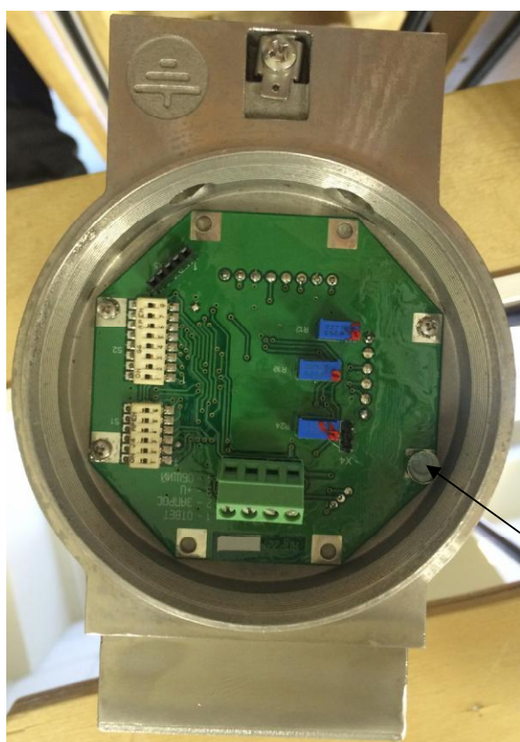
Рисунок 2 - Схема пломбировки от несанкционированного доступа
