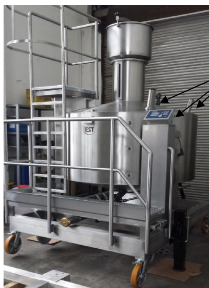
Рисунок 1 - Общий вид установки поверочной MWVP-3000 с местом пломбировки
