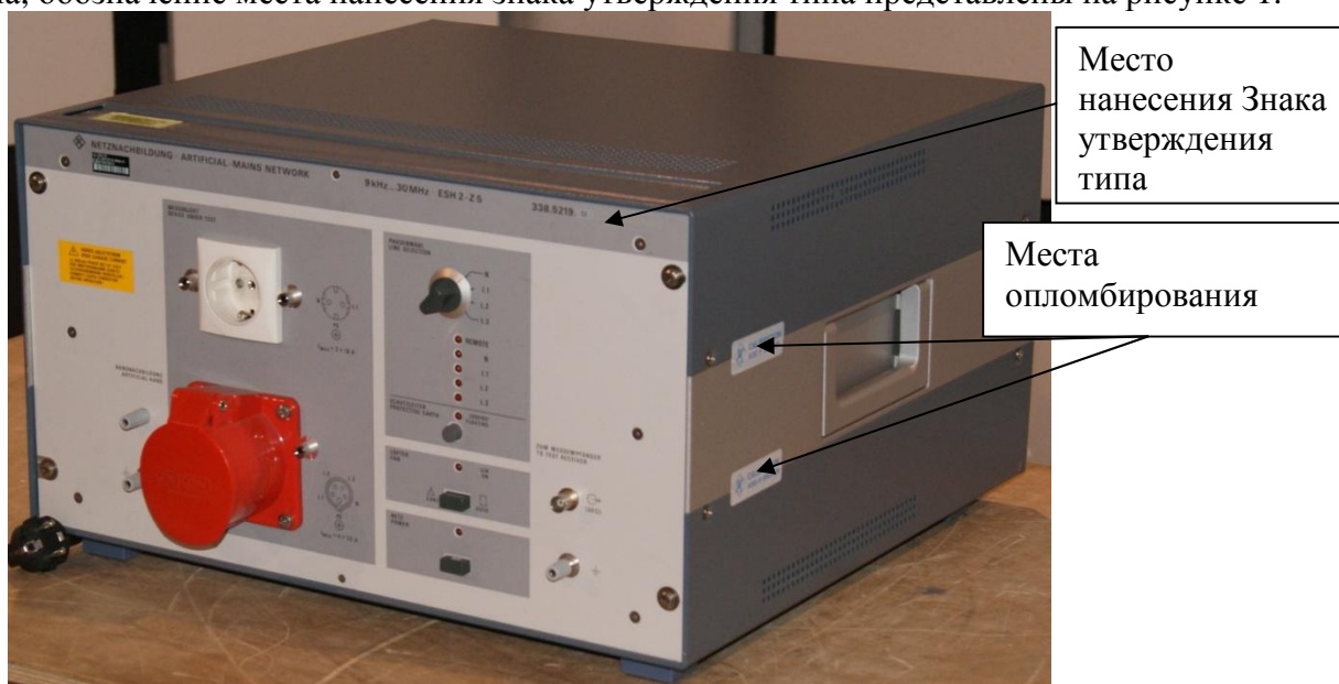
Рисунок 1 - Общий вид средства измерений. Схема пломбировки от несанкционированного доступа, обозначение места нанесения знака утверждения типа
