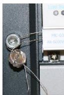
Рисунок 7 - Внешний вид пломбирования крейта МИС-036R с установленными в ней модулями
