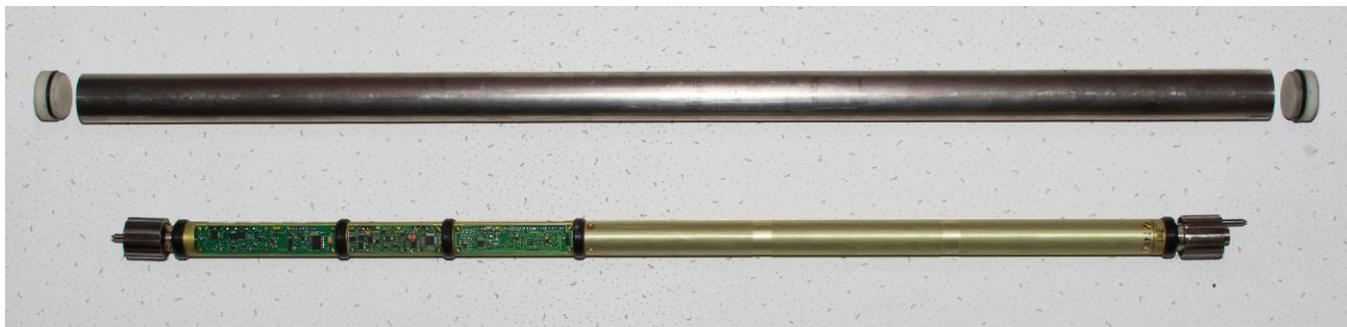
Рисунок 1 - Общий вид модулей инклинометрических МИП 42-120/60 «ЗТК»
