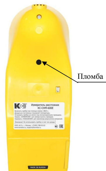
Рисунок 4 - Схема пломбировки от несанкционированного доступа измерителей КС-СНМ-600Е
