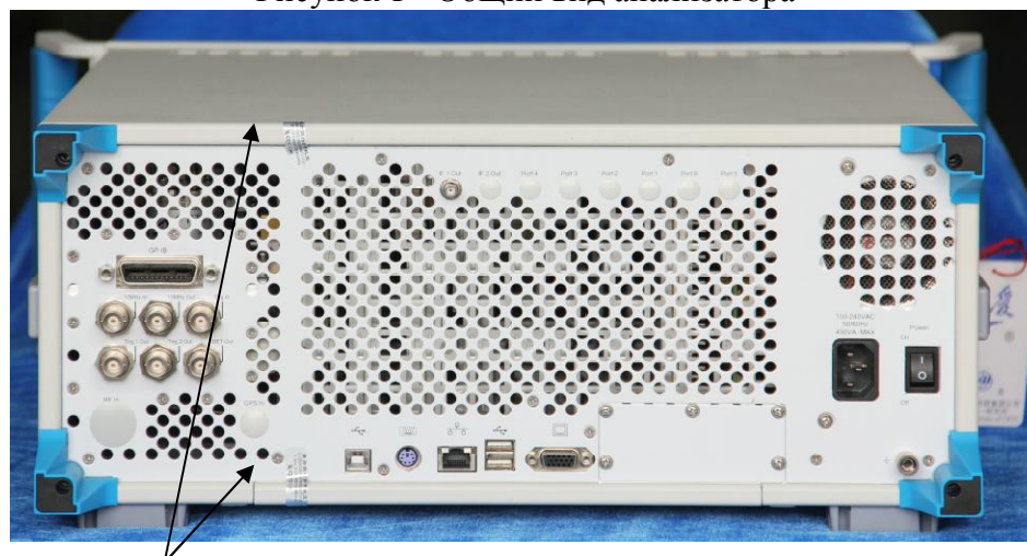
Рисунок 2 - Схема пломбировки от несанкционированного доступа
