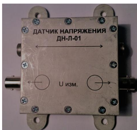
Рисунок 5 - Общий вид датчика напряжения ДН-Л-01
