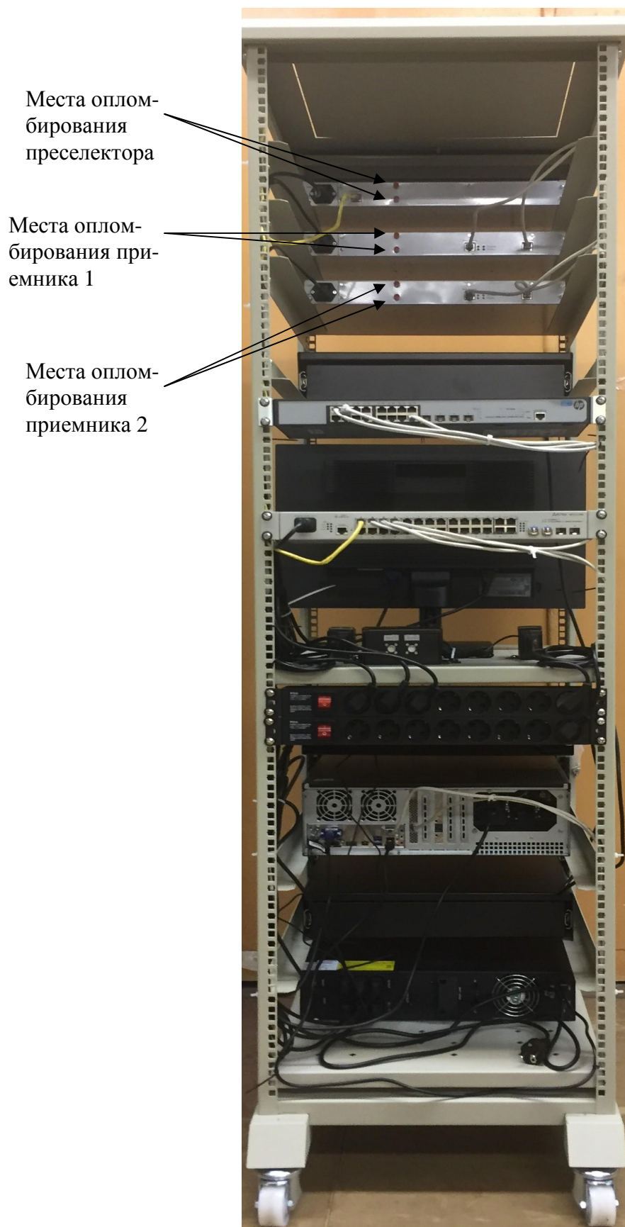
Рисунок 2 - Общий вид стойки с оборудованием комплекса (вид сзади)
