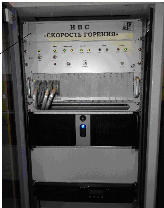
Рисунок 1 - Общий вид «измерительно-вычислительной системы «Скорость горения»
