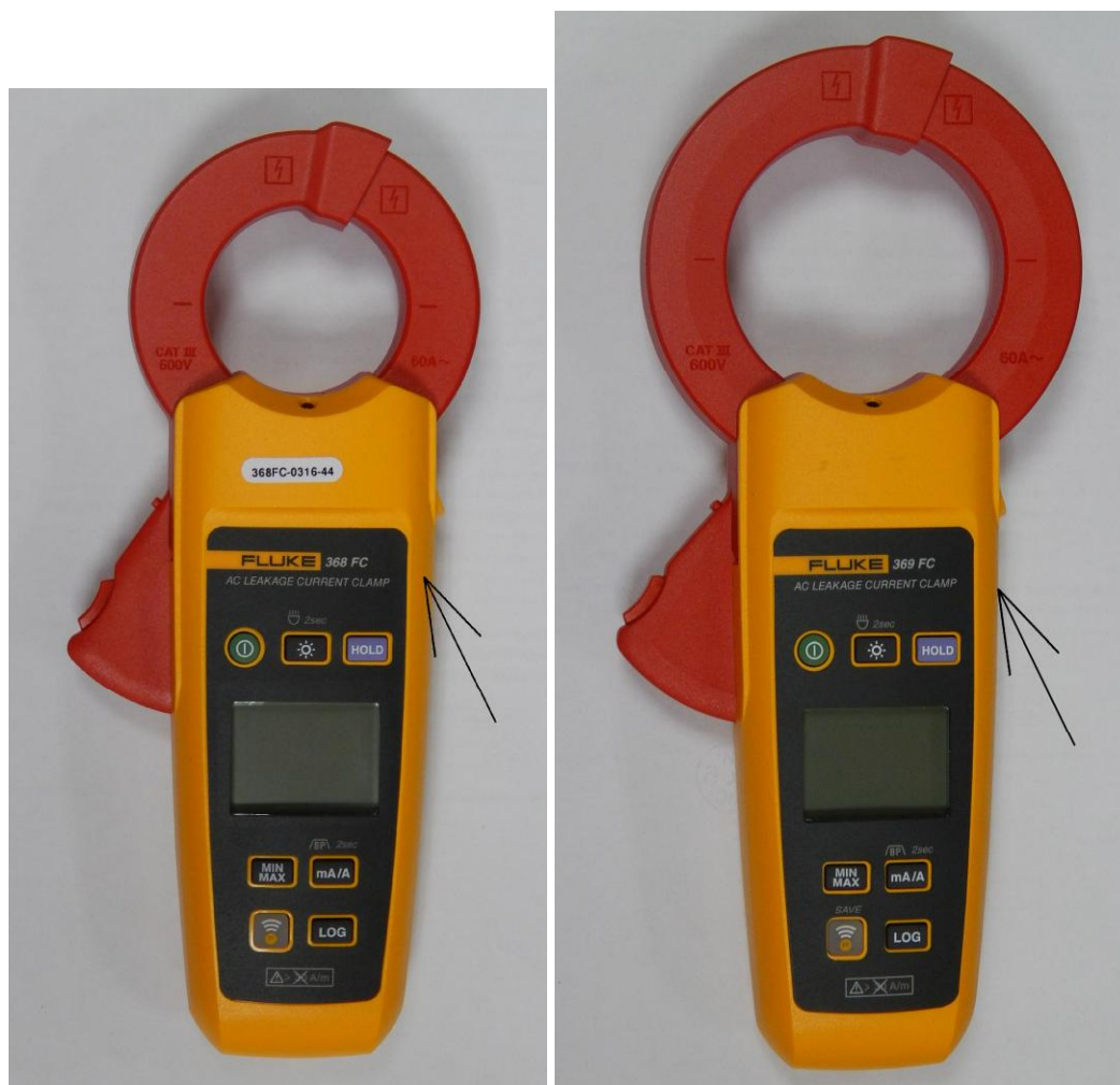
Рисунок 1 - Внешний вид клещей, слева - Fluke 368 FC, справа - Fluke 369 FC. Стрелками на боковой поверхности показаны места нанесения знака утверждения типа и поверительного клейма.
