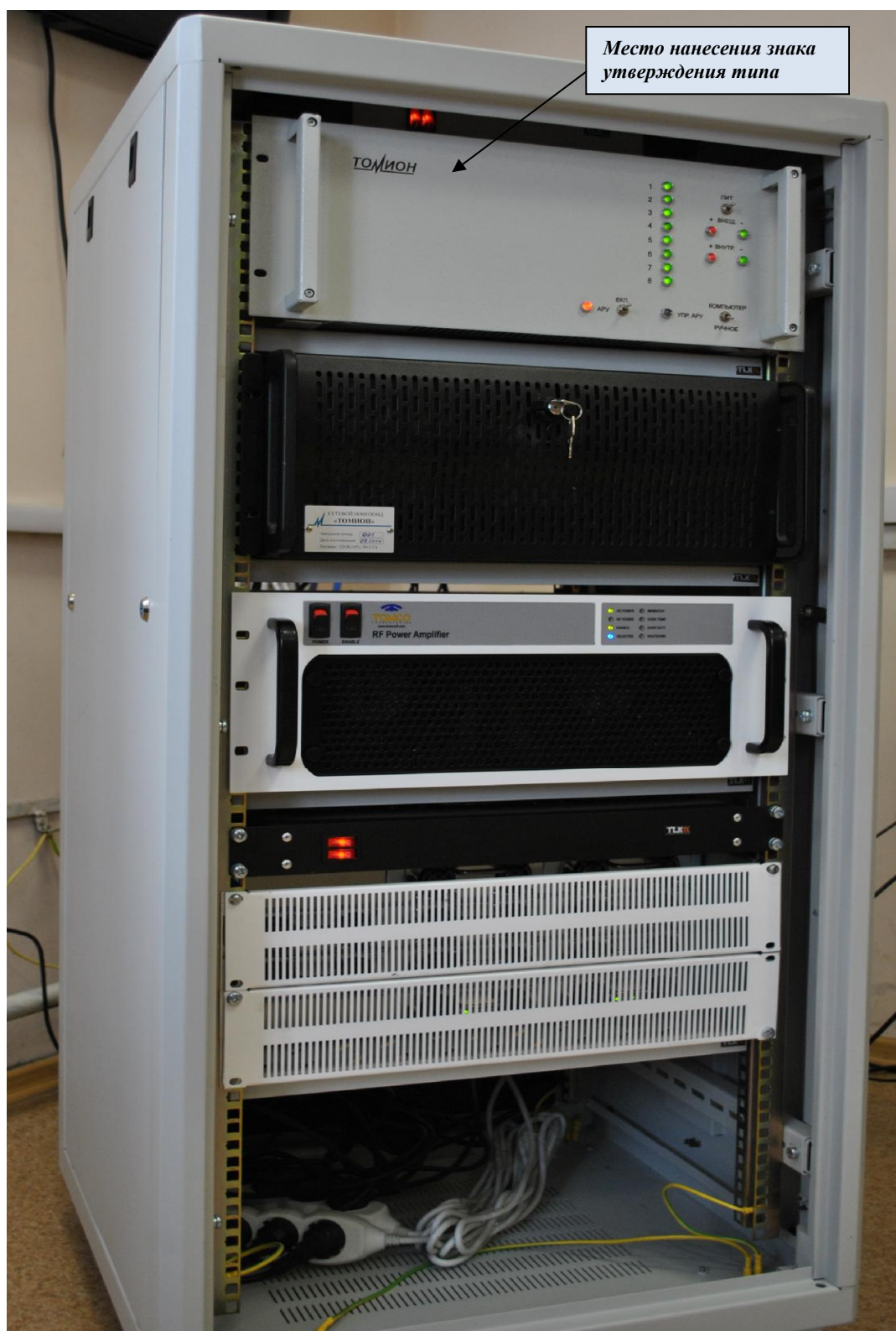
Рисунок 2 - Общий вид ионозонда «ТОМИОН»
