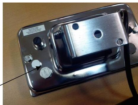
Рисунок 4 - Места пломбирования корпуса терминалов
