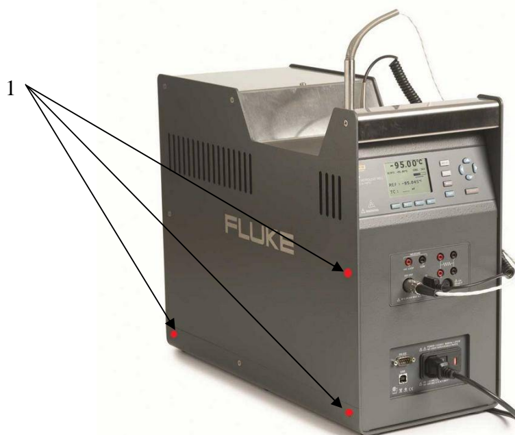
Рисунок 2 - схема пломбирования Комплексов поверочных портативных КПП-2 1 - пломбы на корпусе калибратора температуры сухоблочного Fluke модели 9190A исполнение «-Р».
