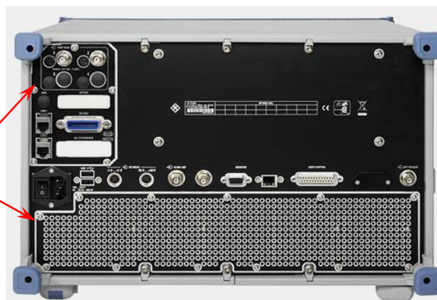
Рисунок 10 - Задняя панель векторного анализатора цепей
