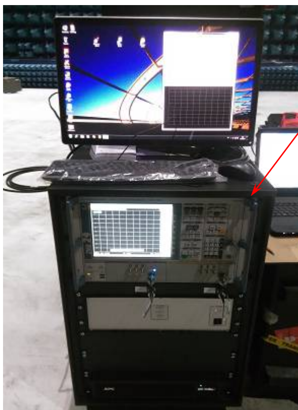
Рисунок 9 - Внешний вид рабочего места оператора с ПЭВМ, предназначенными для управления работой комплекса и обработки результатов измерений
