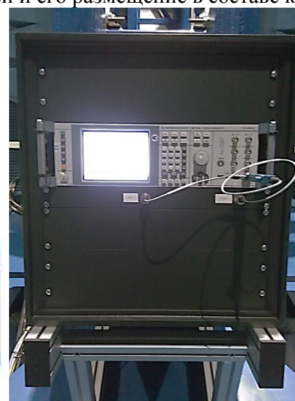
Рисунок 6 - Внешний вид генератора сигналов и его размещение в составе комплекса
