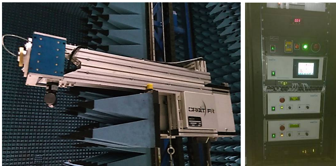
Рисунок 4 - Общий вид оси Z сканера и системы управления сканером
