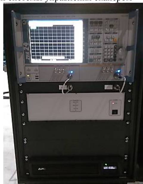
Рисунок 5 - Внешний вид векторного анализатора цепей и его размещение в составе комплекса
