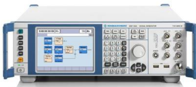
Рисунок 6 - Внешний вид генератора сигналов и его размещение в составе комплекса
