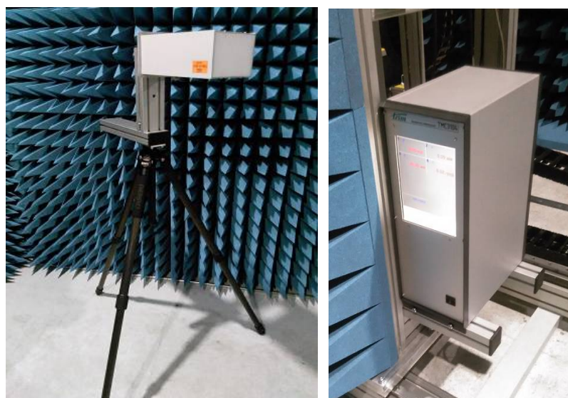
Рисунок 3 - Внешний вид рупорной антенны и контроллера управления сканером
