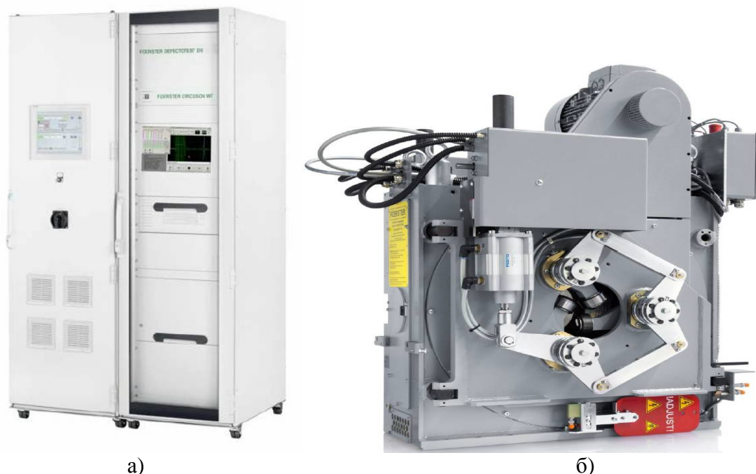
Рисунок 1 - Общий вид системы а) силовой шкаф и электронный шкаф; б) система датчиков Ro 180
