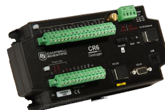
Рисунок 2 - Общий вид регистраторов данных многофункциональных CR6
