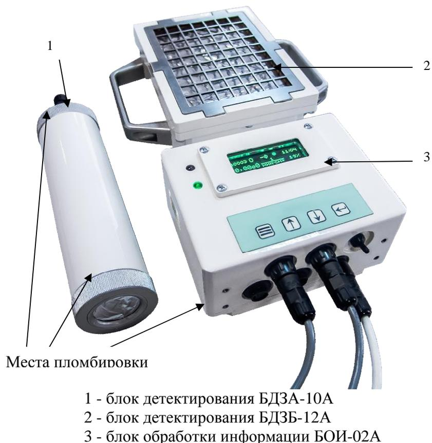
Рисунок 1 - Общий вид радиометра загрязненности поверхности МКС-16А «Флора».
