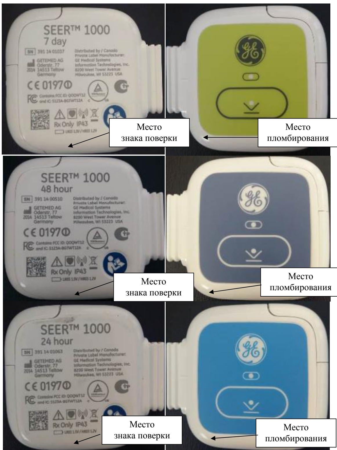
Рисунок 1 - Общий вид, схема пломбировки от несанкционированного доступа, обозначение места нанесения знака поверки
