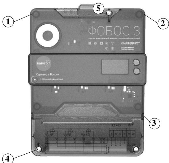
а) счетчики ФОБОС 3 в обычном корпусе
