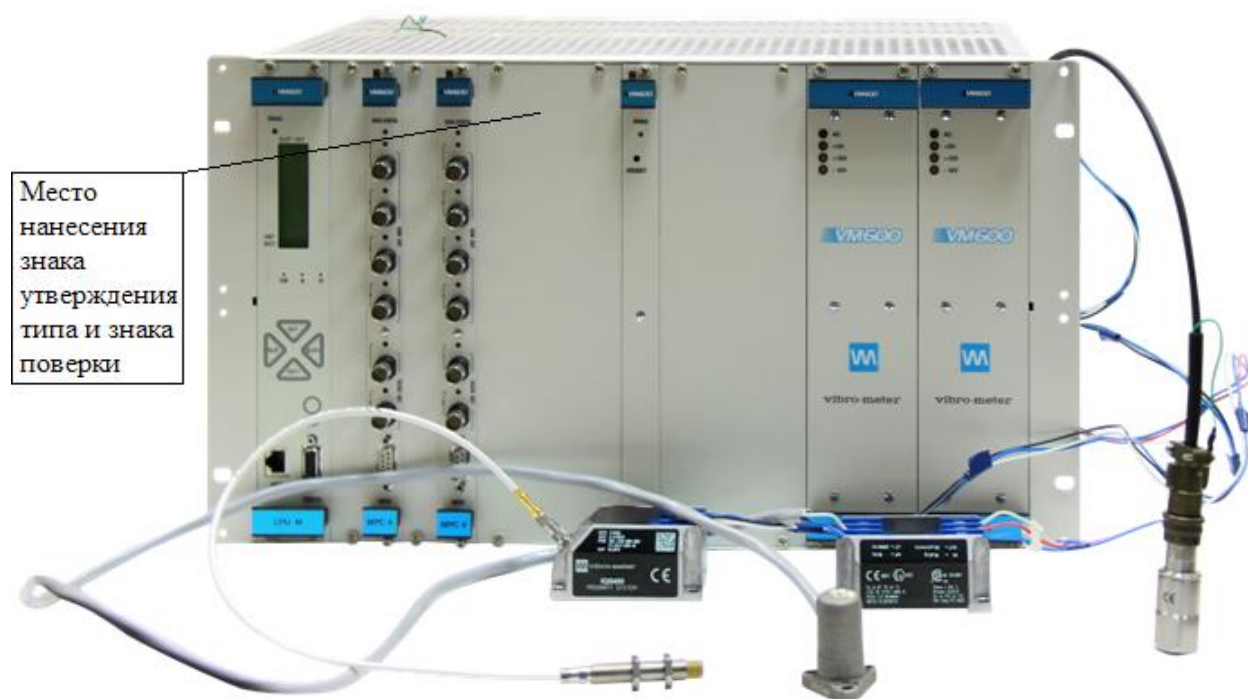
Рисунок 2- Общий вид систем вибромониторинга «ПРОМЕТЕЙ» с контроллером VM600, обозначение места нанесения знака поверки
